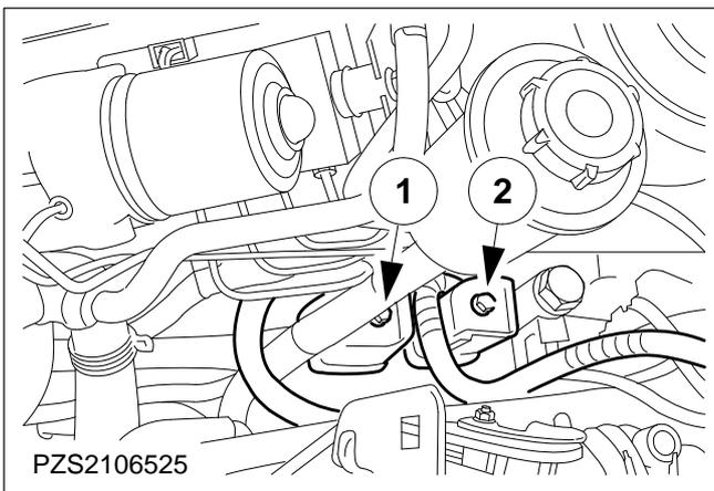
**113. Fit the wiring loom plugs.**
