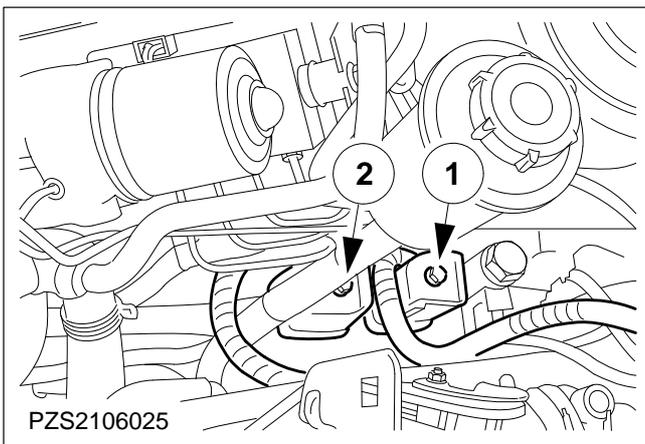
**12. Detach the wiring loom plugs.**
